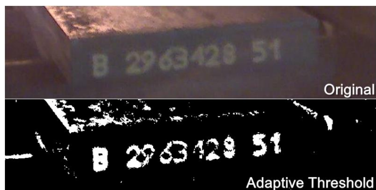
Fig. 3. Exemplo de imagem recebida com iluminação ruidosa seguido da binarização feita através de Adaptive Threshold
