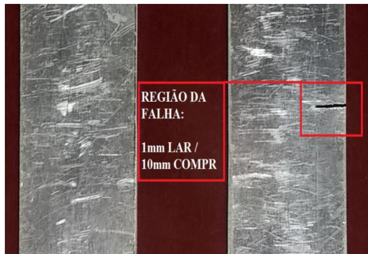
Fig. 4. Demonstração de uma placa sem falha (esquerda) e placa com a falha introduzida (direita).
